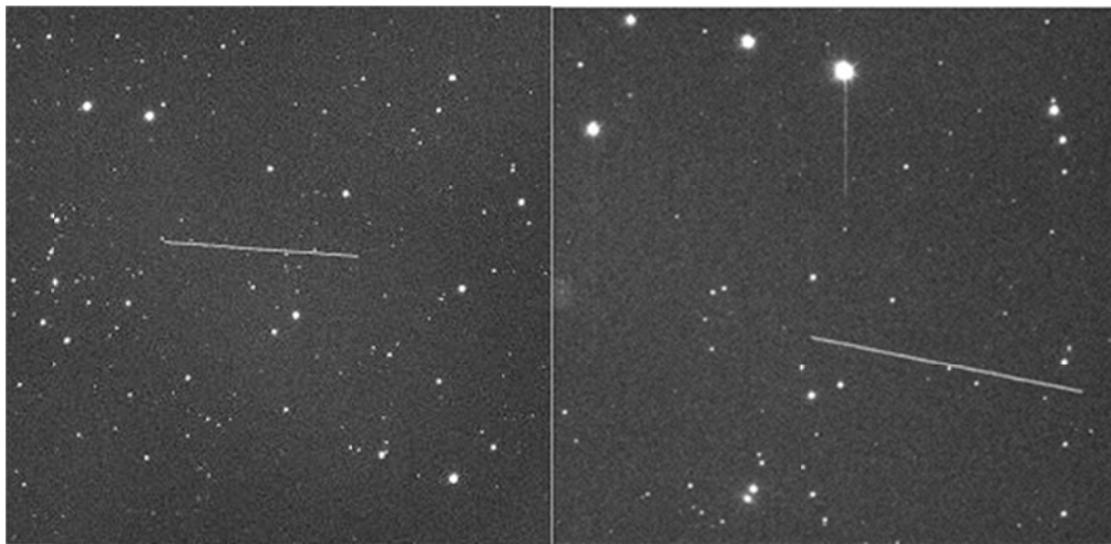
شکل ۵. تصاویر نمونه برداشت شده بوسیله دستگاه iXON Ultra 888 مربوط به ماهواره در مدار LEO
