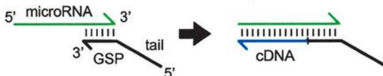
شکل ۴ تصویر شماتیک روش تداوم آغازگر [M]; در این روش ابتدا با استفاده از آغازگری که بخشی از آن ویژه انتهای miRNA 3' است (Gene Specific Primer: GSP) ساخت cDNA انجام می‌شود.
