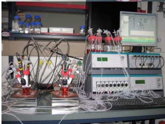
شکل ۴. بیوراکتورهای مخزنی همزن‌دار برای کشت سلول‌های بنیادی ساخت شرکت Dasgip آلمان
