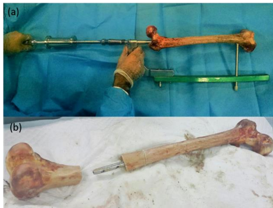
شکل (۶) - (a) داخل کردن میله درون استخوان با استفاده از جیگ مخصوص (b) میله‌ی داخل شده درون استخوان شکسته
