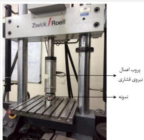
شکل (۲) - دستگاه تست دینامیکی مورد استفاده در تست ریلکسیشن
