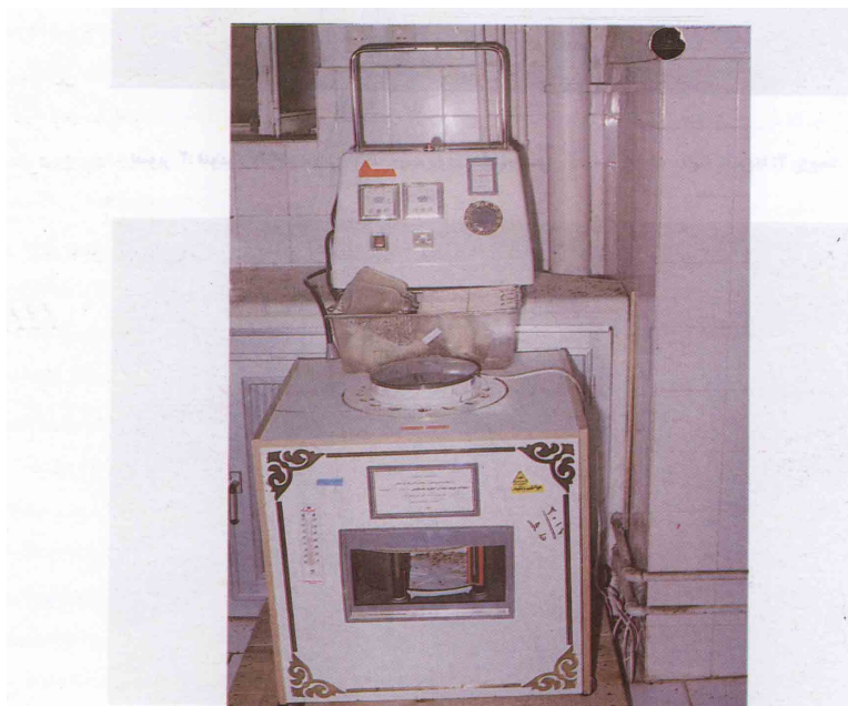
تصویر ۱: دستگاه مولد میدان الکترومغناطیس emf یکنواخت و قابل تنظیم با فرکانس ۶۰ - ۵۰ هرتز و با شدت میدان ۱۵۰ گوس
