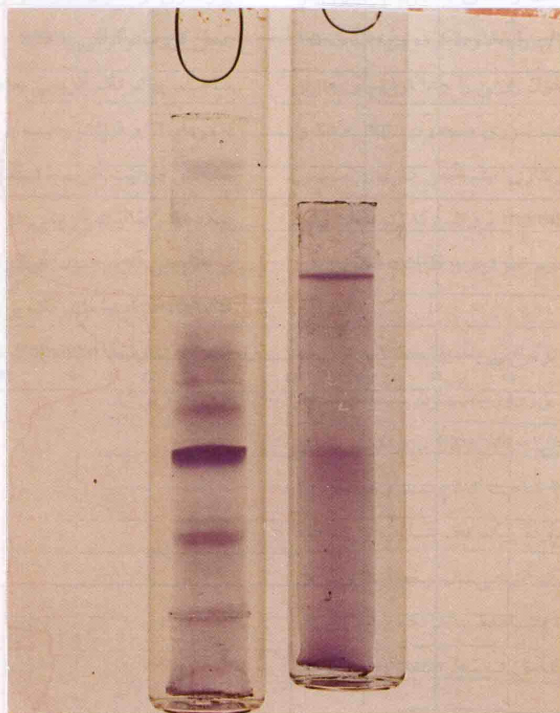
تصویر ۱: باند تک بر روی ژل پلی آکریل آمید در نمونه سمت راست در مقایسه با نمونه ژل پلی آکریل آمید نمونه سمت چپ است که نمونه سمت راست بعد از ژل کروماتوگرافی و نمونه سمت چپ، بعد از کروماتوگرافی تعویض یون است و باند تک بر روی نمونه سمت راست، نشان دهنده خلوص آنزیم در آخرین مرحله جداسازی است.
