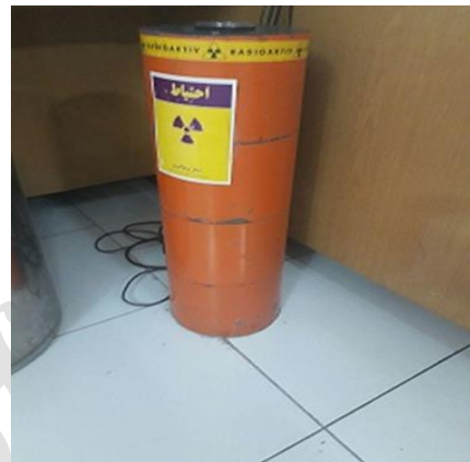
شکل ۱. نمای بیرونی آشکارساز چاهی مورد استفاده در کار مدل 4001M-ORTEC
