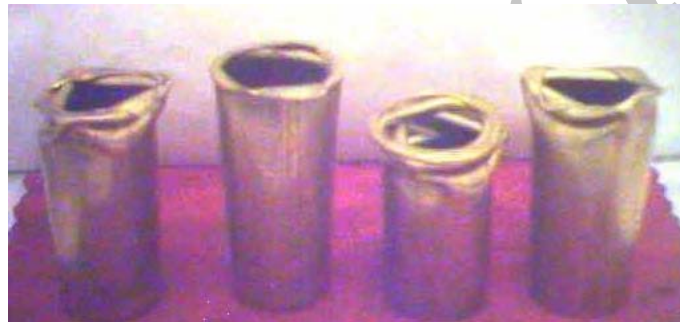
شکل ۱۸- سازه های جدار نازک برنجی تحت آزمایش های انفجار
