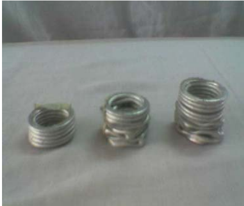
شکل ۵- نمونه های آزمایش شده سازه های استوانه ای از جنس آلومینیوم با تعداد تاخوردگی قابل ملاحظه
