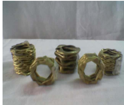
شکل ۶- نمونه های آزمایش شده سازه های استوانه ای از جنس برنج با تعداد تاخوردگی قابل ملاحظه
