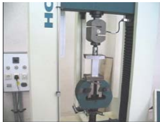
شکل ۲- دستگاه تست کشش- فشار (سازه‌های سلولی با مقطع مربع تحت بارگذاری فشاری)
