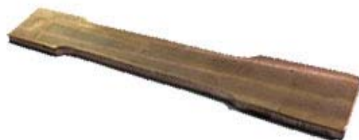
شکل ۳- نمونه مسی تست کشش
