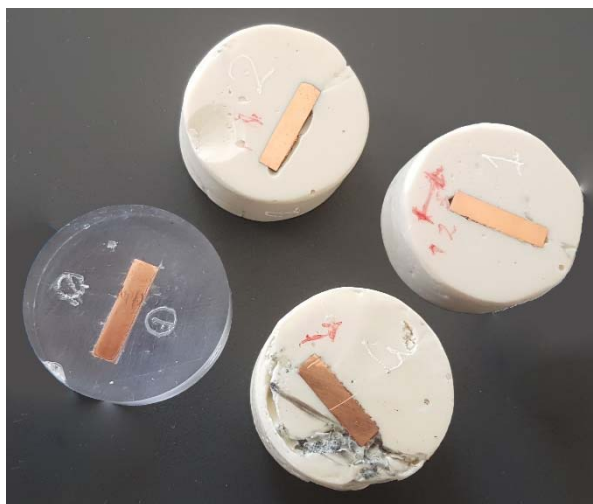
شکل ۵- نمونه‌های مسی آماده شده برای عکس‌برداری نوری
