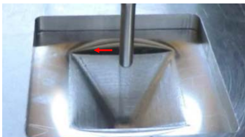
شکل ۲- فرم هندسی از شکل دهی افزایشی ورق سه لایه جوش انفجاری Al/Cu/Al
