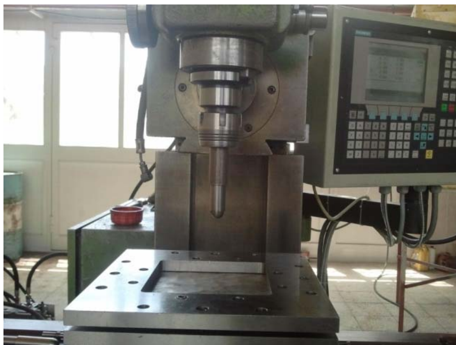
شکل ۱- نمایی از نحوه قرارگیری و حرکت ابزار در شکل دهی افزایشی
