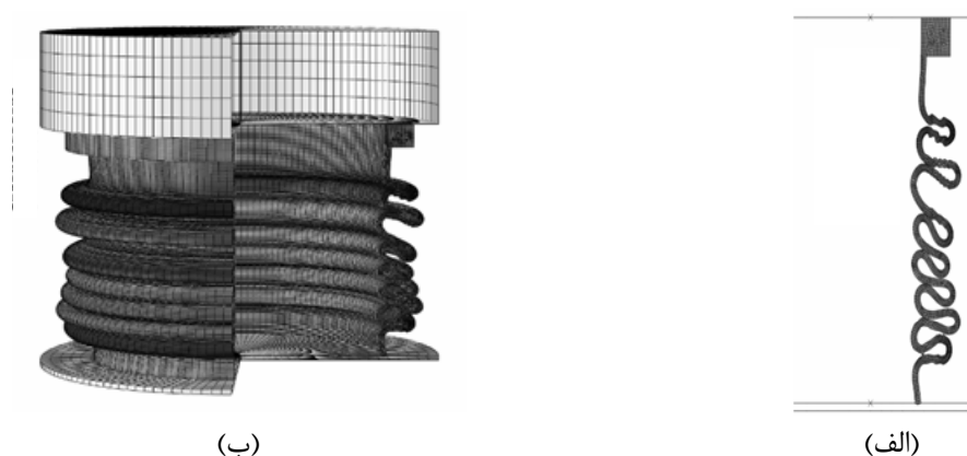
شکل ۲ - تغییر شکل و چین خوردگی لوله آلومینیومی با استفاده از کد ABAQUS/Explicit
