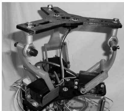
شکل ۷- ربات 3-RRS فضایی ساخته شده با پرینتر سه بعدی
