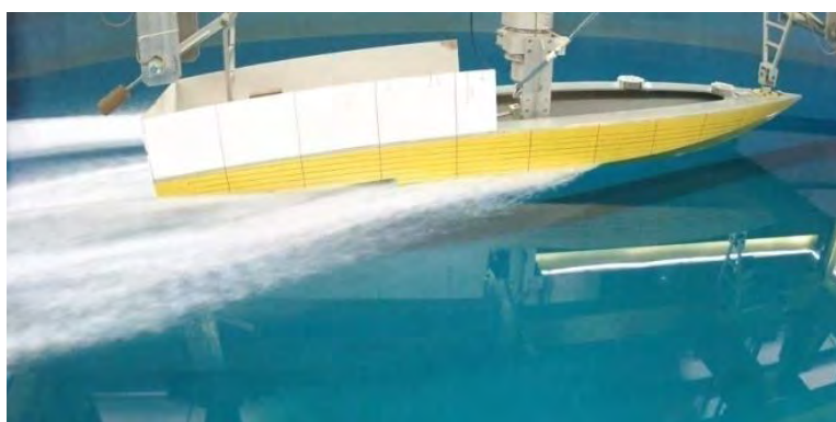
شکل ۵- تست مدل شناور دو پله کوگار B در آزمایشگاه دریایی خلیج فارس
