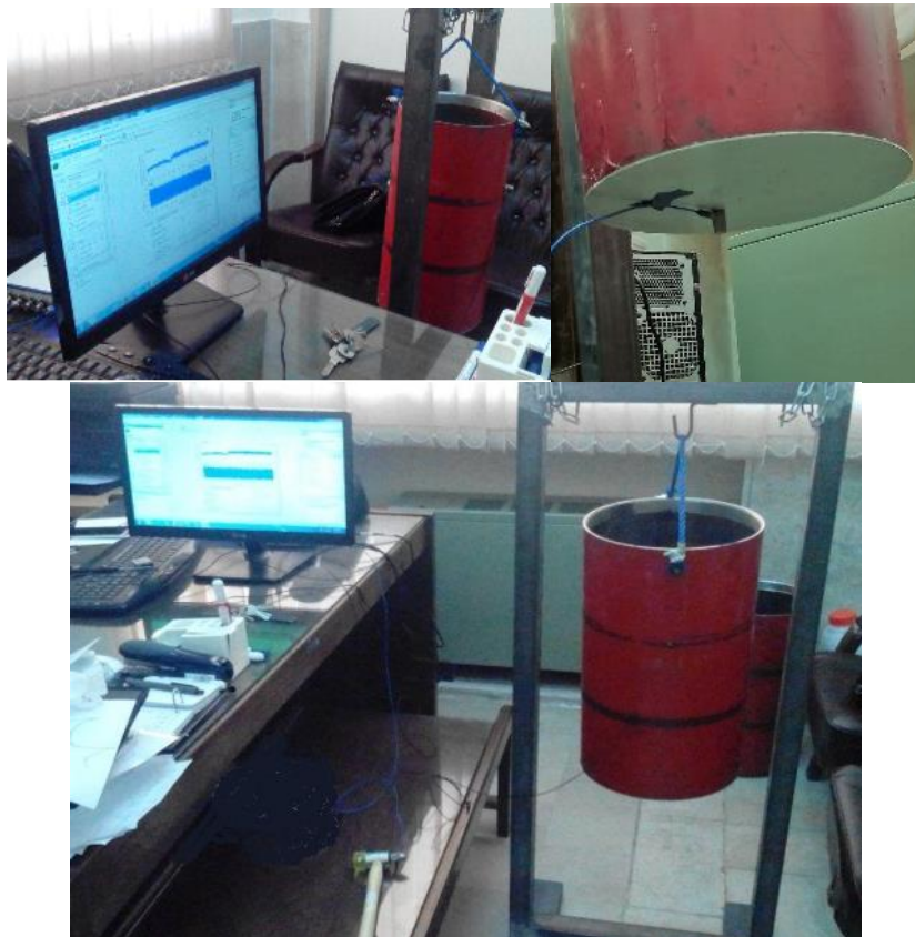
شکل ۴- آزمایش مودال ورق دایروی و نحوه نصب تجهیزات
