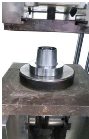
شکل ۵- نحوه قرار گرفتن لوله مخروطی دوجداره یکسرگیردار در دستگاه یونیورسال برای انجام آزمون ها
