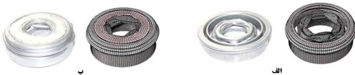
شکل ۱۳- مقایسه فروریزش در حالت‌های تجربی و عددی، الف) نمونه دو جداره توخالی،
