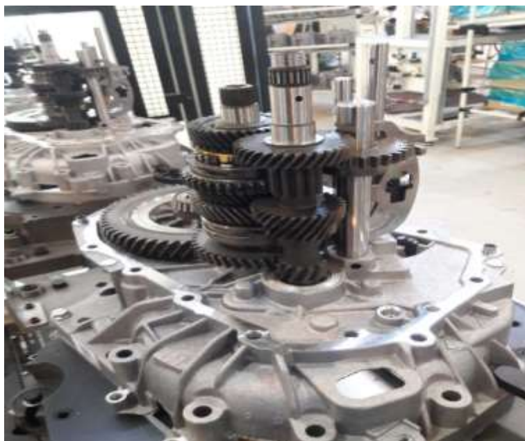
شکل ۴- نمای داخل گیربکس سواری تندر ۹۰
