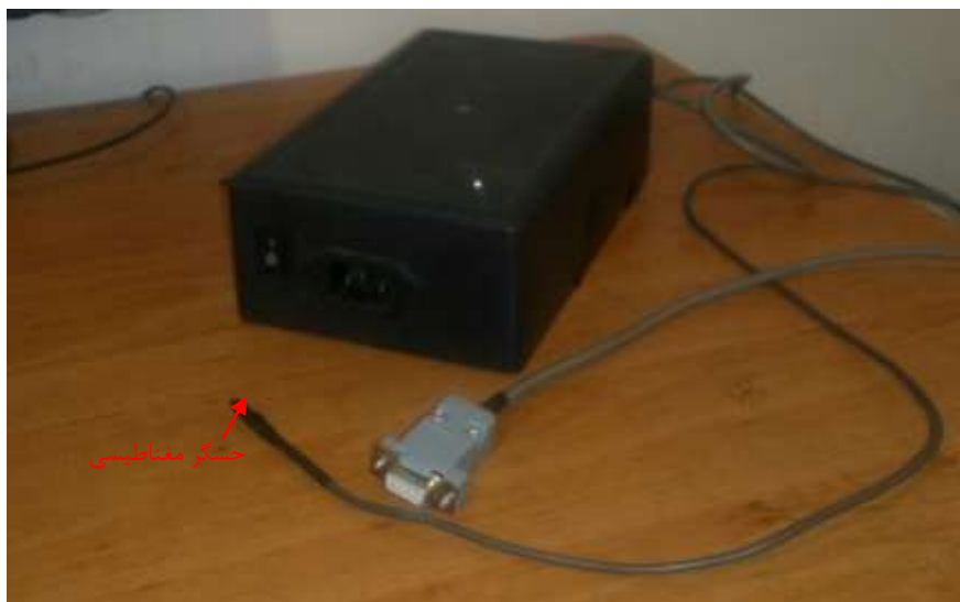
شکل ۶- جعبه برد الکترونیکی و حسگر مغناطیسی سرعت دورانی
