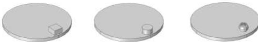
شکل ۴- مقایسه سه شکل کروی، استوانه‌ای و مکعبی برای آهنربای دائمی
