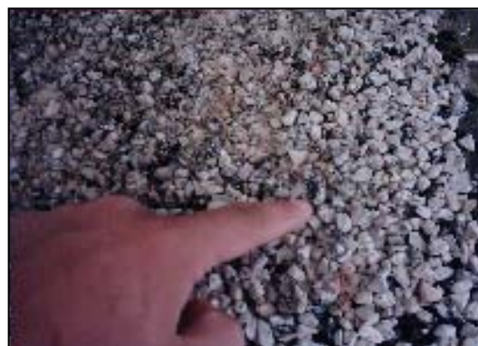
شکل ۱. اثر بار اضافی و خردشدگی سنگدانه ها، همچنین اثر میزان سنگدانه اضافی
