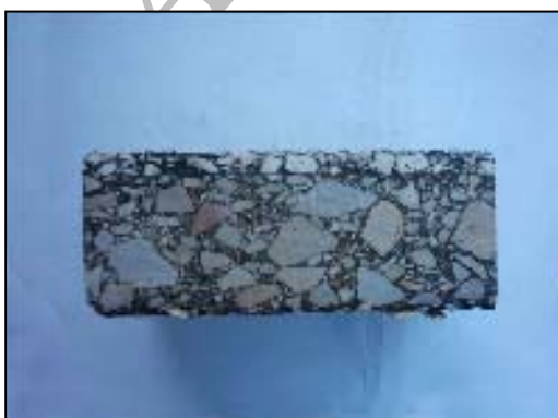
شکل ۳. مقطع اندود دولایه با محل شیار
