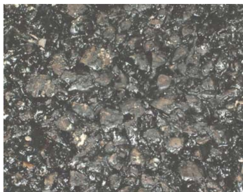
شکل ۱. نمونه آسفالت متخلخل ساخته شده در آزمایشگاه [۷]
