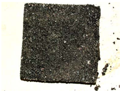
شکل ۳. نمونه آسفالت با دانه بندی پیوسته یا آسفالت بتنی [۷]
