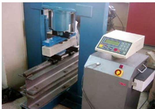
شکل ۳. نحوه قرار گرفتن نمونه خمشی زیر دستگاه
