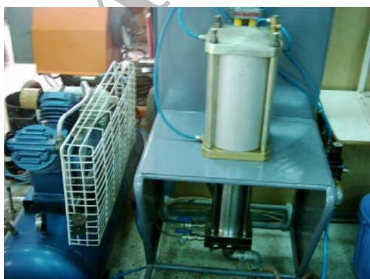
شکل ۴. تجهیزات آزمایش تعیین ضریب نفوذپذیری بتن
