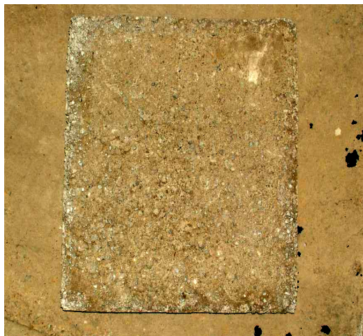
شکل ۳. نمونه بتنی ساخته شده در آزمایشگاه بافت درشت ایجاد شده به وسیله سنگریزه با سایز ۱۰ میلی‌متر
