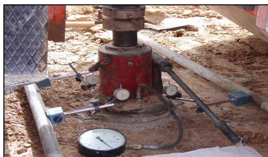
شکل ۷. آزمایش بارگذاری صفحه در محل نقطه ۱
