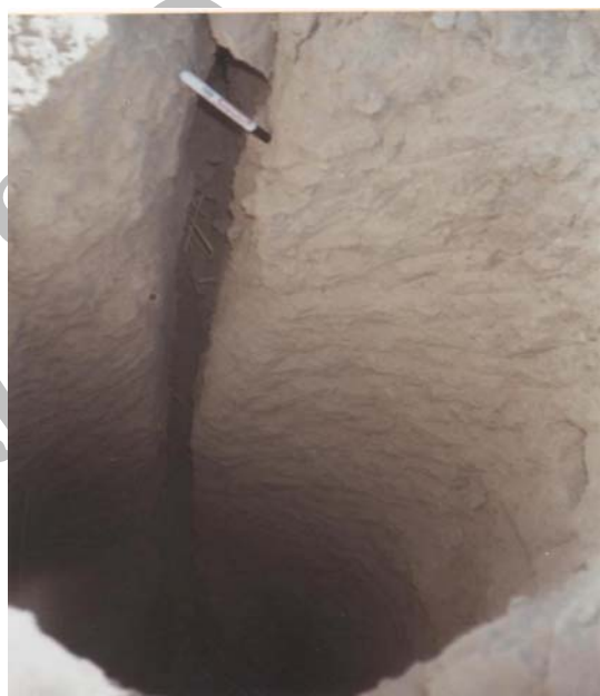
شکل 6. تصویر شکاف در عمق دو متری در گمانه دستی
