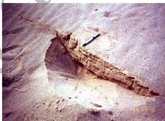
شکل 12. کناره حفره مرکزی گسیختگی‌ها که به وسیله ماسه بادی پر شده است.
