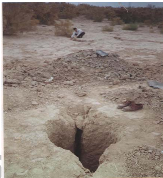
شکل 8. گسیختگی محیطی در زمینی که گمانه دستی در آن حفر شده است.
