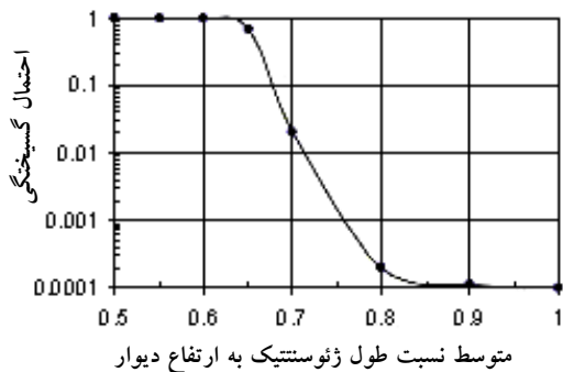
شکل ۱۰. احتمال گسیختگی در مقابل متوسط نسبت طول ژئوستتیک به ارتفاع دیوار
