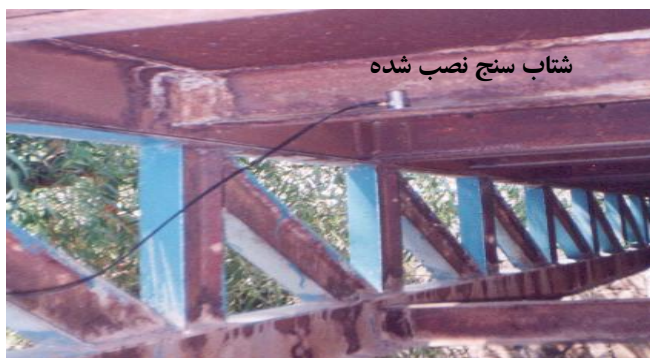
شکل ۱۳. تصویری از شتاب‌سنج نصب شده بر روی یکی از تیرهای فرعی پل (نقطه ۲۵ در شبکه تعریف شده در شکل ۸)
