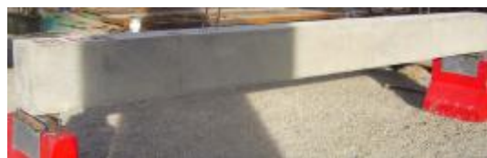
(الف) تیر بتنی ساخته شده در آزمایشگاه، تحریک شده توسط چکش ۱
