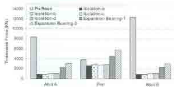
شکل ۴. برش عرضی کوله ها و پایه پل اول تحت زلزله ناغان (a)
