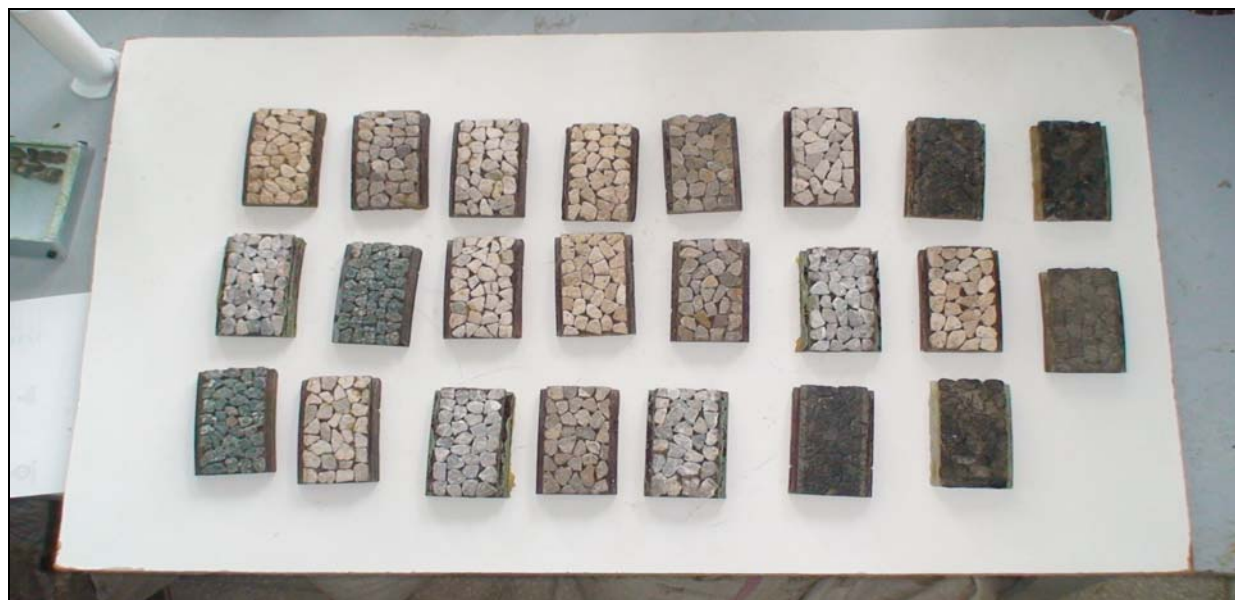
شکل ۴. نمونه‌های رزینی آماده شده برای آزمایش صیقل
