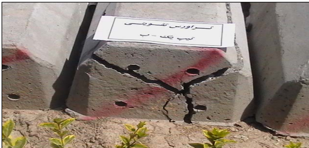
شکل ۱۳. تأثیر آزمایش کتراک بر روی تراورس تقویتی با شبکه آرماتورهای معمولی
