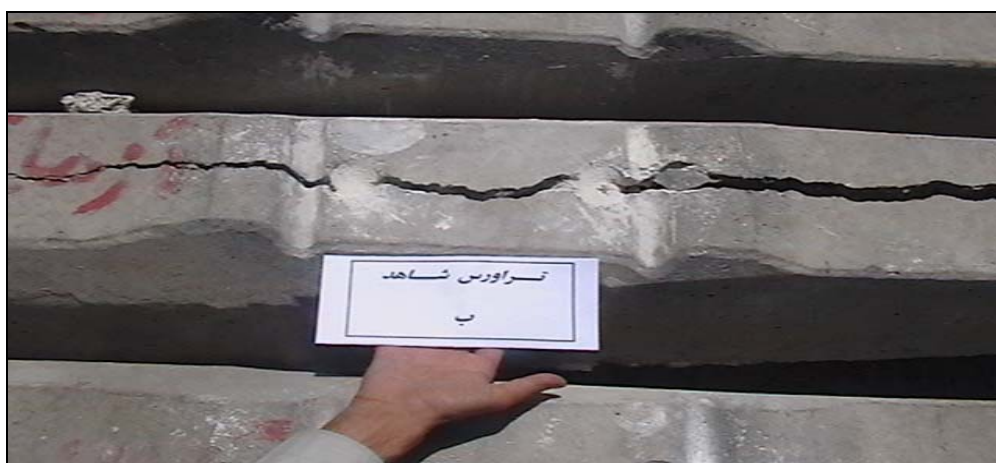
شکل ۱۲. تأثیر آزمایش کتراک بر روی تراورس تقویت نشده
