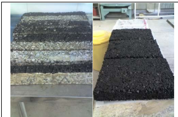
شکل ۵. دال و تیرچه‌های آسفالتی ساخته شده در آزمایشگاه
