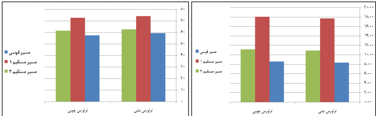
شکل ۱۰. رفتار کمانش بر حسب نوع تراورس (الف) درجه حرارت کمانش (°C) (ب) بیشینه تغییر مکان جانبی (mm)
