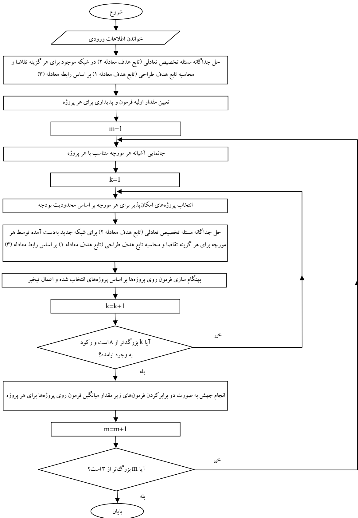
شکل ۲. روش حل مسئله طراحی شبکه در شرایط تقاضای متغیر با استفاده از الگوریتم دسته مورچگان
