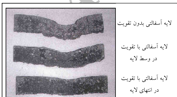
شکل ۲. برش عرضی لایه آسفالتی با و بدون تقویت تحت ترافیک (Technical Guideline, 2008)
