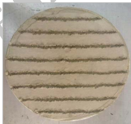
شکل ۱. نمونه بتنی دارای بافت درشت به روش شیارزنی
