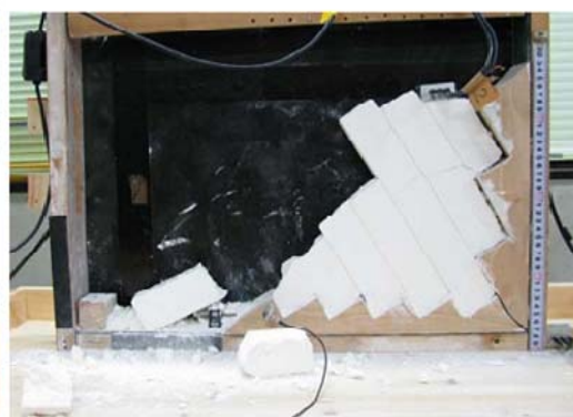
شکل ۱۶. مدل‌سازی فیزیکی شیروانی سنگی دارای پتانسیل شکست واژگونی خمشی (شیب لایه‌بندی ۴۵ درجه)
