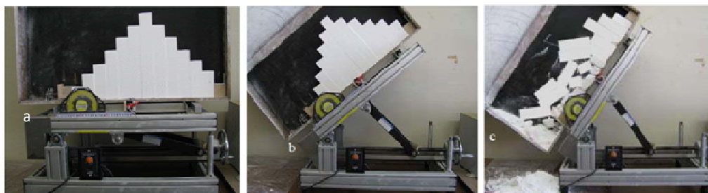
شکل ۷. مدل‌سازی فیزیکی شیروانی سنگی دارای پتانسیل شکست وازگونی خمشی استاتیکی
