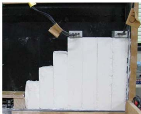
شکل ۱۵. مدل‌سازی فیزیکی شیروانی سنگی دارای پتانسیل شکست واژگونی خمشی (شیب لایه‌بندی ۹۰ درجه)
