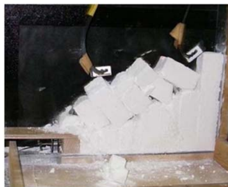
شکل ۱۵. مدل‌سازی فیزیکی شیروانی سنگی دارای پتانسیل شکست واژگونی خمشی (شیب لایه‌بندی ۹۰ درجه)
