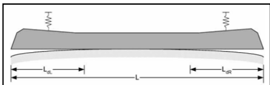
شکل ۱۰. الگوی تماس خرابی آویختگی دو طرفه
