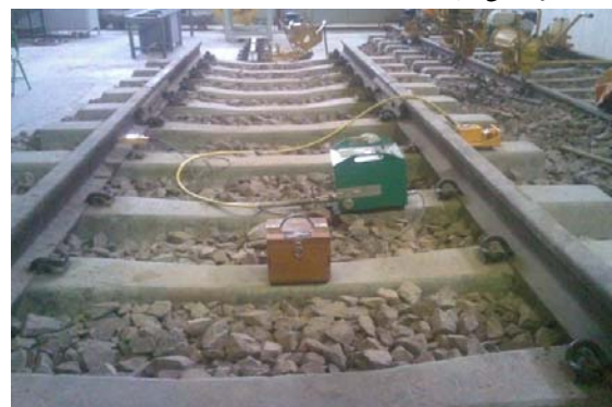
شکل ۴. نحوه نصب اجزای دستگاه روی خط
