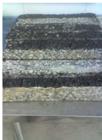
شکل ۲. دال و تیرچه‌های آسفالتی ساخته شده در آزمایشگاه
