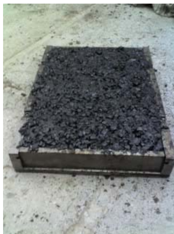
شکل ۲. دال و تیرچه‌های آسفالتی ساخته شده در آزمایشگاه
