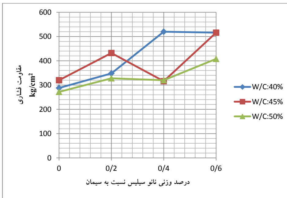
نمودار ۷. مقاومت فشاری بتن با نانو سیلیس
