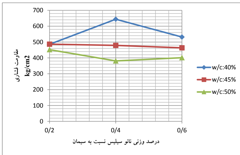
نمودار ۸. مقاومت فشاری تک محوره نمونه ۷۰ روزه با نانو سیلیس در محلول سود
