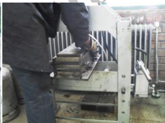
شکل 3. نمایی از نحوه ساخت و تراکم دال
