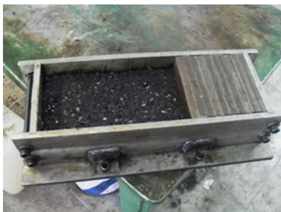
شکل 3. نمایی از نحوه ساخت و تراکم دال
