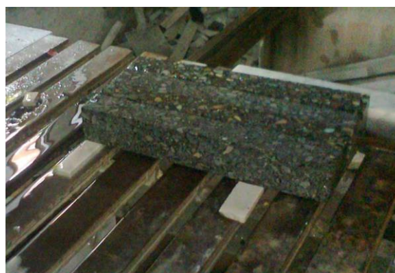
شکل 4. نمایی از نحوه برش دال
