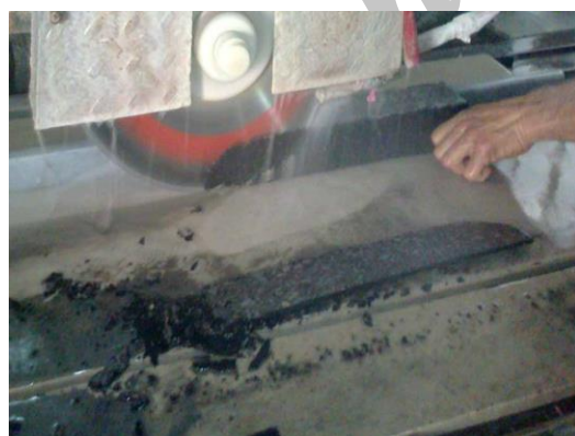
شکل 4. نمایی از نحوه برش دال
