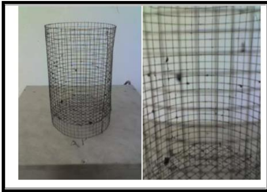
شکل 4. سبد استفاده شده برای انجام آزمایش ریزش قیر
