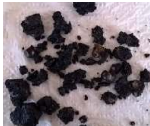
شکل ۷. اندود سنگدانه ها در نمونه های حاوی ۱۰۰ درصد سنگدانه تازه پس از آزمایش عریان شدگی مرطوب
