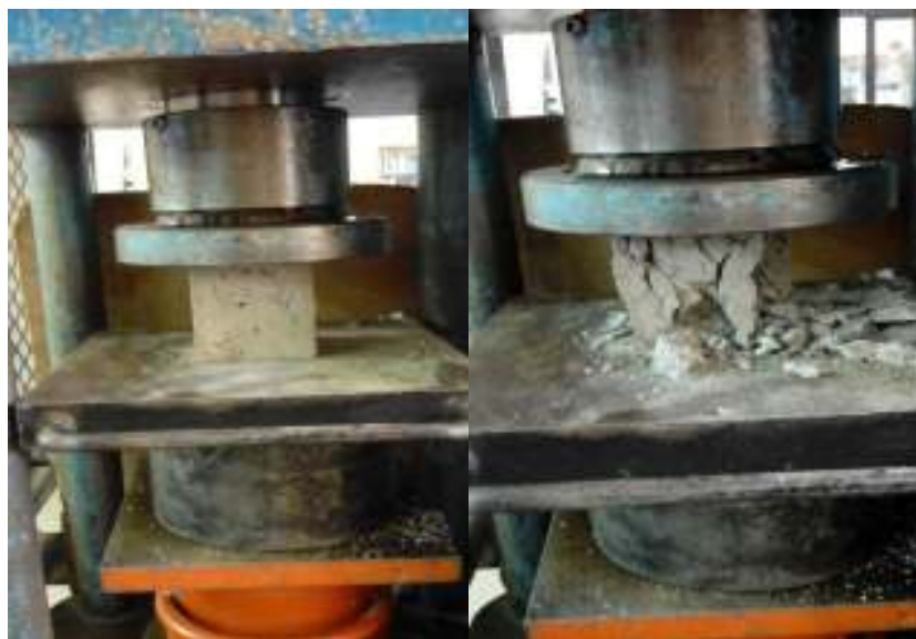
شکل ۶. آزمایش مقاومت فشاری و نحوه خرد شدن نمونه‌ها
