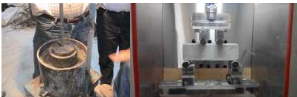
شکل ۳. بارگذاری نمونه تیرچه (سمت راست) برای تعیین انرژی شکست و مدول الاستیسیته و نحوه متراکم کردن نمونه بتن غلتکی در آزمایشگاه-میز وی بی (سمت چپ) (رامی، ۱۳۹۰)
