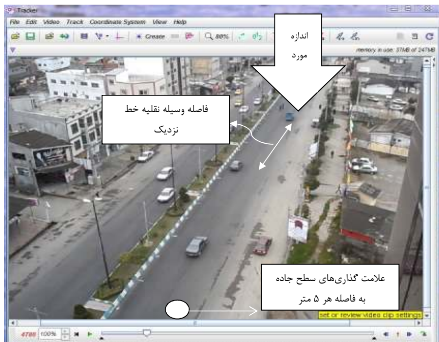
شکل ۲. یک نمونه استخراج داده از فیلم ضبط شده در داخل نرم افزار tracker
