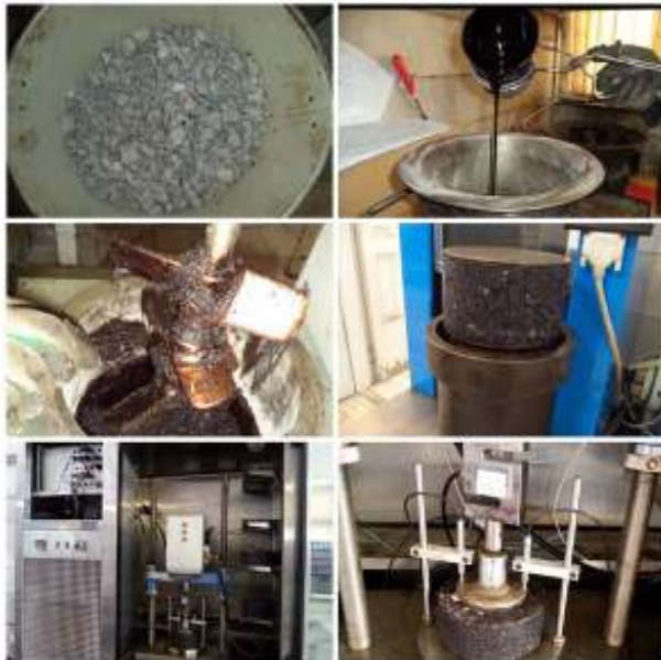
شکل ۳. مراحل ساخت نمونه‌ها و انجام آزمایش خزش دینامیکی
