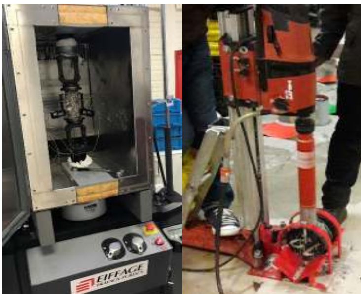
شکل ۲. دستگاه بارگذاری هیدرولیک MTS 370 جهت انجام آزمایشات مدول دینامیکی (بالا) و ابزار طراحی شده برای کرگری (پایین)
