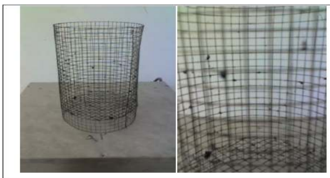
شکل ۴: سبد استفاده شده برای انجام آزمایش ریزش قیر
