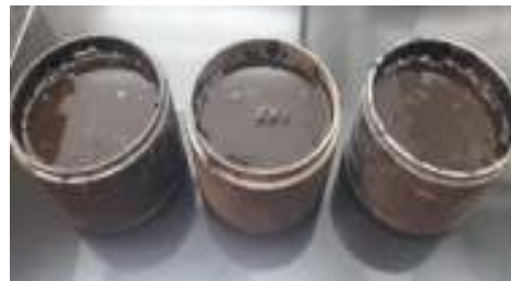
شکل ۳. نمونه های اساس متراکم در آزمایش نفوذپذیری امولسیون
