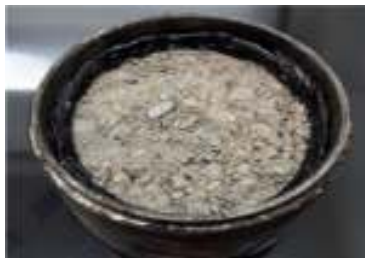
شکل ۴. آب بندی فاصله میان دیواره قالب و مخلوط مصالح اساس
