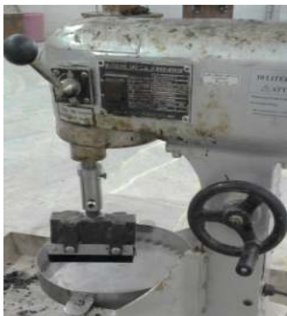
شکل ۳. دستگاه آزمایش جاروب ساخته شده در آزمایشگاه
